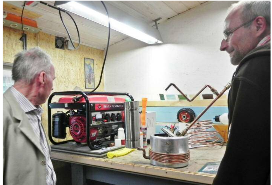
Uli Schuhmacher zeigt dem Redaktor seinen 5-PS-Benzingenerator zur Stromerzeugung, der auf Wasserstoff umgebaut werden soll, sowie einen Experimentalaufbau eines Wärmetauschers für seinen Plasmareaktor.
