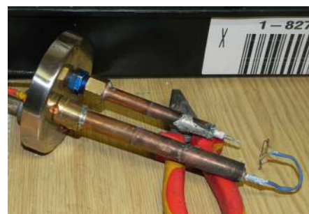
Aus dem grossen Wasserbehälter ausgebaute Elektrodenanordnung.
