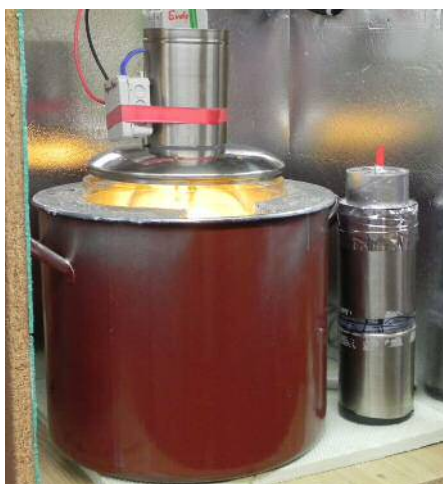
Grosser Wasserbehälter mit eingebautem Plasma-Reaktor-Gefäss.
