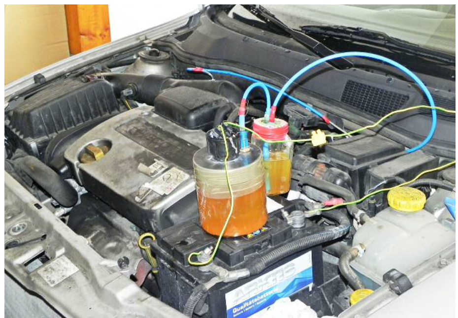
Elektrolysesystem aus Glasbehältern mit Natronlaugenlösung und Kontaktelektroden, die an die Autobatterie angeschlossen sind. Das beim Fahrbetrieb erzeugte HO-Gas wird der Mischluft zugeführt.
