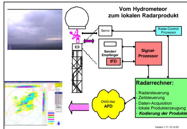
Die Antenne des Radarsystems strahlt einen auf ca.  $1^\circ$  gebündelten, elektromagnetischen Puls von bekannter Frequenz, Länge und Leistung ab. Niederschlagsteilchen streuen diese Energie und senden sie teilweise zur Antenne zurück. Aus der Laufzeit des Empfangssignals lässt sich die Entfernung bestimmen. Die als Reflektivität bezeichnete Stärke des Echos liefert Hinweise über Größe und Beschaffenheit des Niederschlagsteilchens (siehe Bild).
