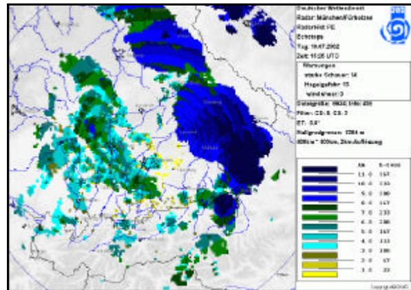
Das **Echotop-Produkt PE** (rechtes Bild) stellt die maximalen Höhen für die erfassten Radarreflektivitäten (oberhalb eines vorgegebenen Reflektivitätsschwellenwertes) dar. Die Meteorologen des DWD nutzen das PE-Produkt für die Vorhersage von Schauer und Gewitter.
