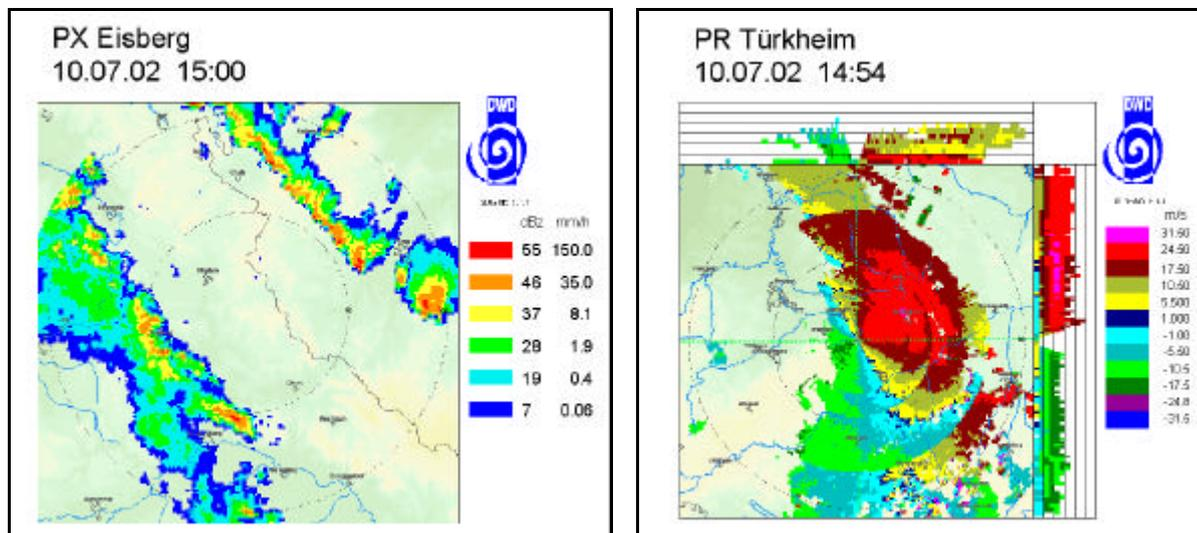
Aus der Dopplerverschiebung lassen sich Windgeschwindigkeiten errechnen. Das **PR-Produkt** (Bild rechts) stellt die radarbezogene Radialwindgeschwindigkeit einer Schicht als lokales Radarbild in einem Geschwindigkeitsbereich von + 32 m/s bis – 32 m/s in zwölf Klassen dar. Das heißt man sieht, aus welcher Richtung der Wind auf das Radargerät zuweht. Dies ist eine wichtige Information für die Flugwetterberater des DWD.
