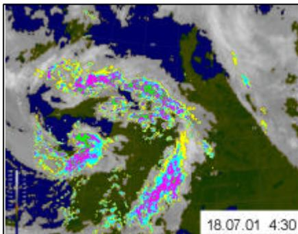
Innerhalb des DWD ermöglichen die Radarprodukte eine flächendeckende Niederschlagsüberwachung und bieten wichtige Informationen für die Kurzzeitfristprognose insbesondere zur Warnung vor Starkniederschlagsereignissen und Hagelgefahr. Durch Überlagerung von Radarbildern und Satellitenbildern, die Informationen über Wolkengattungen und -verteilungen bereitstellen, lassen sich Niederschlagsereignisse an Fronten und Konvergenzlinien klar definieren.
