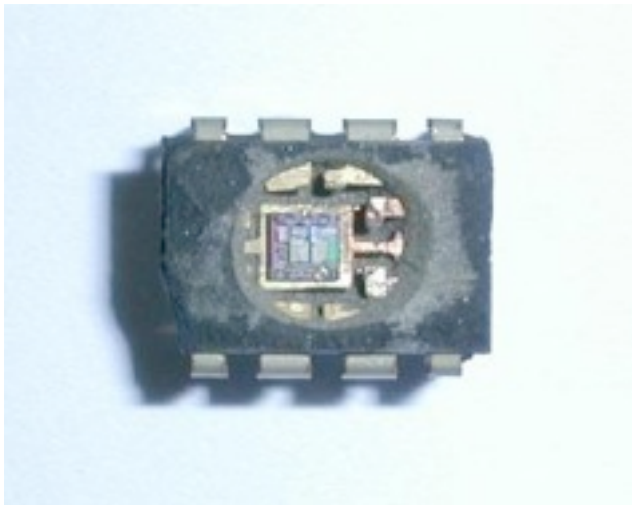
Chip mit sichtbarem Chipkern
