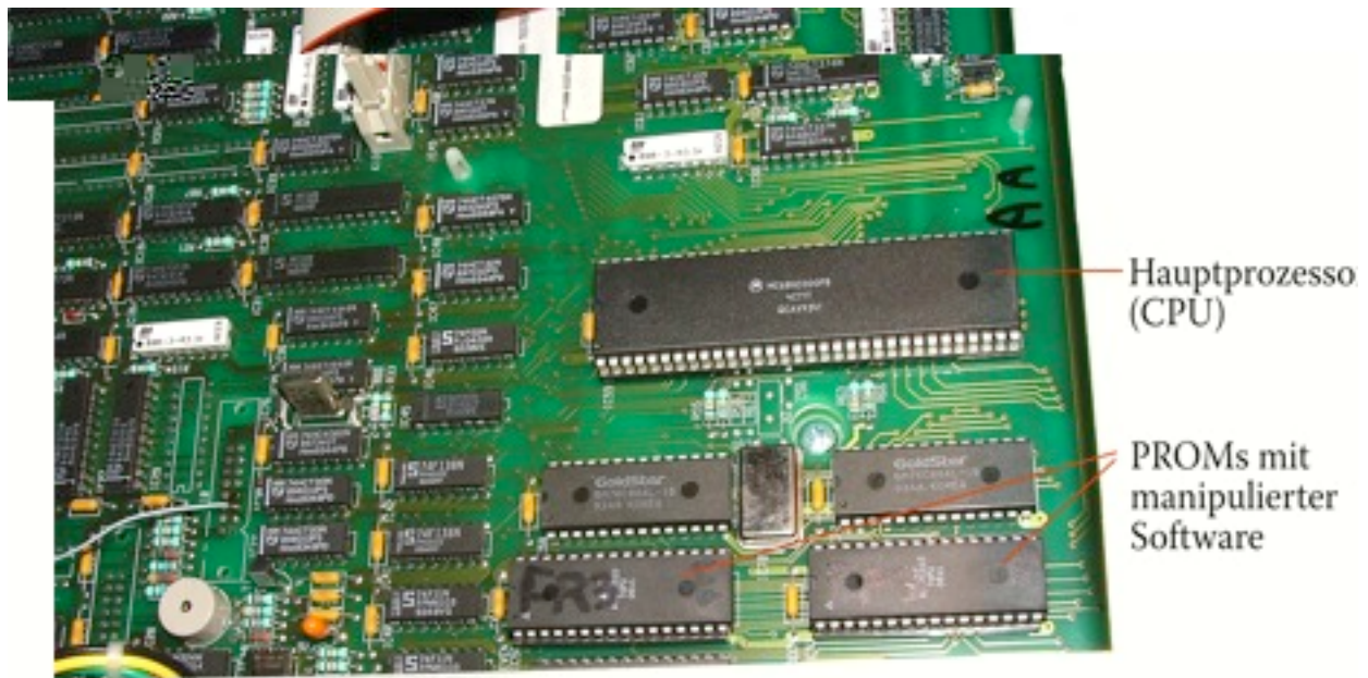
Hauptprozessor und PROMs auf Chipsockeln
