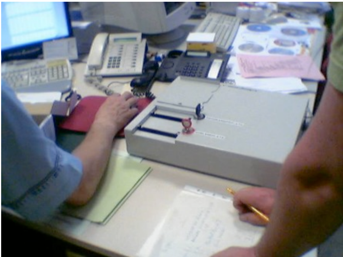
Ausleseinheit bei einer Wahlbeobachtung, Programmierschlüssel (rot) steckt, obwohl dies zum Auslesen nicht erforderlich sein sollte
