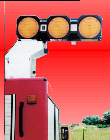
ggf. Triblitz und Warnblickanlage
